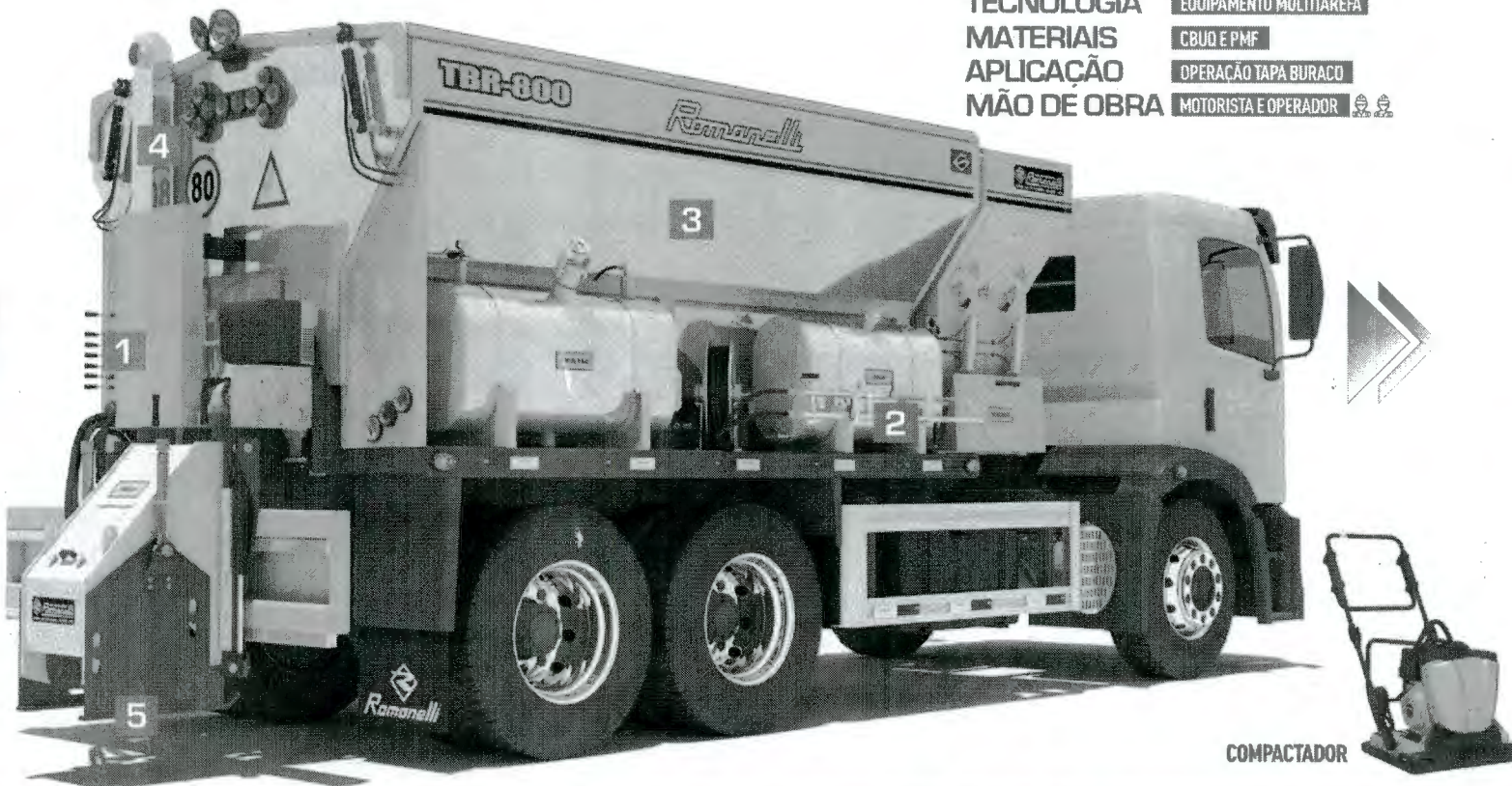
1 CORTE 2 REMOÇÃO DE MATERIAL 3 LIMPEZA DO LOCAL 4 PINTURA DE LIGAÇÃO 5 DISTRIBUIÇÃO DO MATERIAL 6 COMPACTAÇÃO
